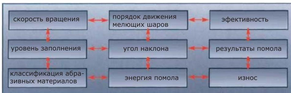
Поэтому шары не должны ударять по керамической футеровке. Наиболее важным параметром, позволяющим избежать ударного износа, является скорость вращения и уровень заполнения мельницы.
